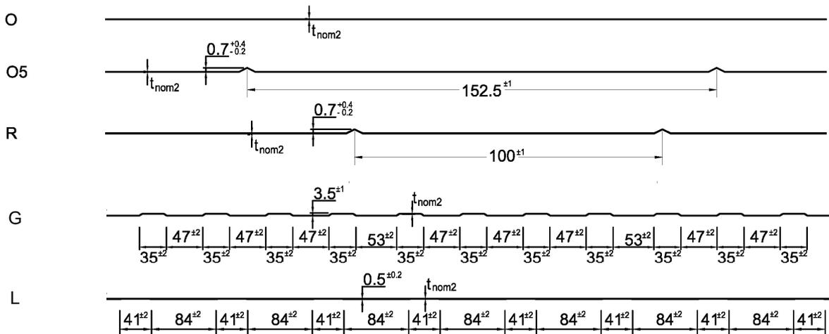
Tragende Sandwichelemente "Ondatherm-", "Pflaum-" und "Promisol-" "AM03" mit einer PUR-Kernschicht zwischen Stahldeckschichten; für Außenwand- und Dachkonstruktionen
